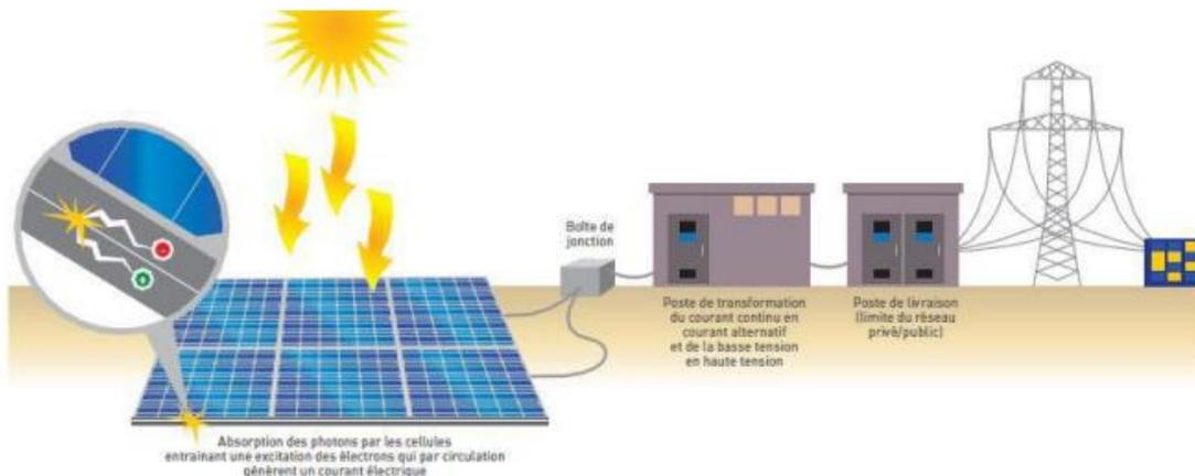
Figure 21 : Liaison entre la production solaire sur site et l'alimentation au réseau national
